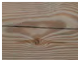
Spannungsriss durch die Holztrocknung
